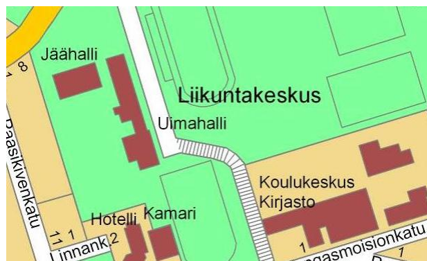
Kuva 6. Rakennuspaikan valinnassa energiantehokkuusnäkökulman kannalta on tärkeää tutkia aina mahdollisuus hyödyntää ylimääräinen lauhdelämpö hallin lähiympäristössä esim. Kankaanpää. Kankaanpään jäähallin lauhdelämpöä hyödynnetään viereisessä uimahallissa. Vuonna 2007 jäähalli myi uimahallille 88,7 MWh lämpöenergiaa käyttöveden esilämmitykseen.
